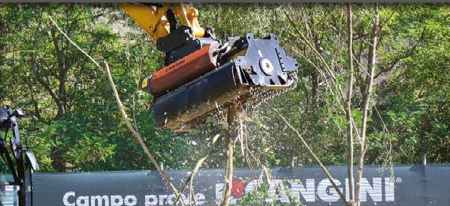
PROJETÉ POUR DES UTILISATIONS TRÈS PÉNIBLES, CE BROYEUR EST CARACTÉRISÉ PAR SA COQUE RENFORCÉE, TANDIS QUE LES ROULEMENTS SONT PROTÉGÉS PAR BLINDAGE. COUTEAUX EN Y ET LAME INTERMÉDIAIRE OU MARTEAUX, VANNES BYPASS, RÉGULATRICES DE FLUX ET LIMITEURS DE PRESSION (POUR TC0-50 ET TC0-70 SEULEMENT LES LIMITEUR RÉGULATRICES DE PRESSION). GRÂCE AU SYSTÈME DE DRAINAGE INTÉGRÉ, IL NE NÉCESSITE PAS DE TUYAUX DE DÉCHARGEMENT AU RÉSERVOIR JUSQU'À CONTRE-PRESSIONS MAX. DE 10 BAR.
